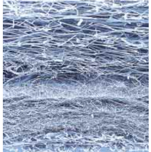
3-lagiges Vliesstoff-Filtermedium, mittlere Schicht elektrostatisch gesponnene Mikrofasern
