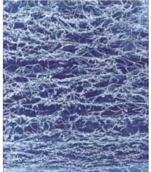
Progressiv aufgebautes Vliesstoff-Filtermedium
